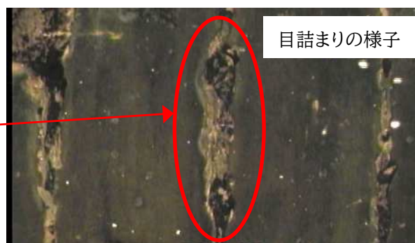
■写真 7-2 井戸ケーシングスリット拡大図 (参考写真)
